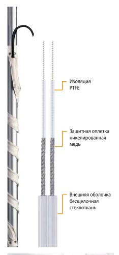
ELW-GN – нагревательная лента с заводской концевой заделкой и изоляцией из стекловолокна специально разработана для обогрева приборов, механизмов и систем в некоррозионной среде; преимущественно используется для обогрева стеклянных приборов и систем, поверхность которых требует деликатного обращения.
